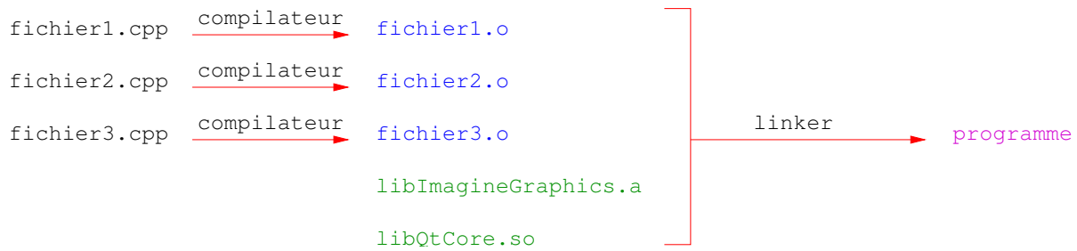
FIGURE C.1 – Phases de compilation et d'édition de liens. Les extensions sont les conventions des systèmes Unix (Linux et Mac), sous Windows les fichiers objet sont en .obj , les bibliothèques en .lib et le programme en .exe .
